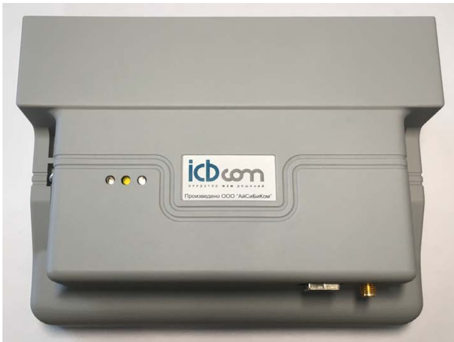
Рисунок 1. Крышка ретрофит LoRaWAN для счетчика Меркурий М230
